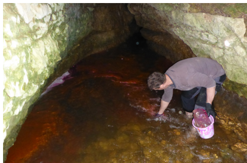
Figura 7.11 - Operação de injeção de traçadores em um sumidouro do sistema cárstico de Arcy-sur-Cure (França). © J. Rodet-2017.
