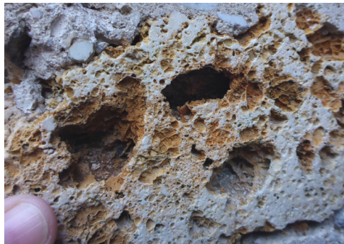
Figure 2.80 - Bloco de meulière com morfologia cavernosa, resultado da transformação da rocha calcária carstificada em uma rocha silicosa. © J. Rodet-2023.
